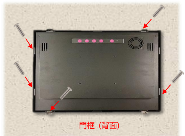
步驟 3: 從背面裝上卡扣後, 以螺絲固定 (視需求或位置限制, 最多可裝 9 個卡扣)
