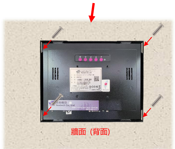
步驟 3: 從背面裝上卡扣後, 以螺絲固定 (視需求或位置限制, 最多可裝 8 個卡扣)
