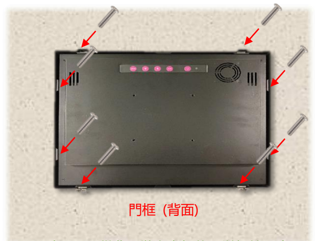
步驟 3: 從背面裝上卡扣後, 以螺絲固定 (視需求或位置限制, 最多可裝 10 個卡扣)
