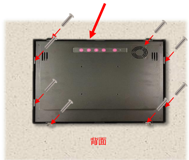
步驟 3: 從背面裝上卡扣後, 以螺絲固定 (視需求或位置限制, 最多可裝 9 個卡扣)
