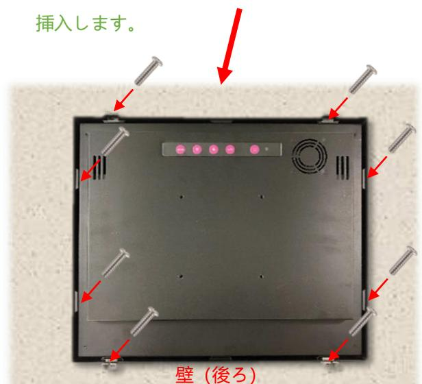
ステップ3: 裏側からクリップを取り付け、ネジで固定します。(最大10個のクリップを取り付けることができます。)
